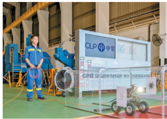
中電模擬「爬行機械人」於引水渠檢查的情況。工程人員示範應用「籠網式航拍機」。
